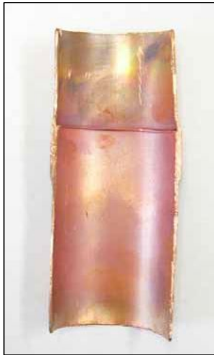
窒素純度 98.0% 窒素流量 6NL/min 1吋4分
